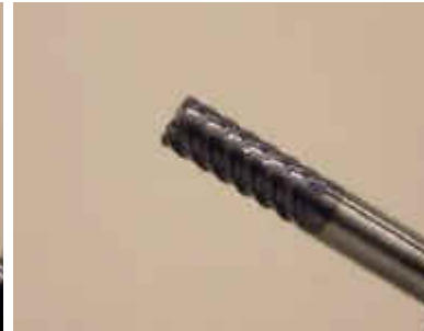
Fig. 3.- Herramienta toroidal de 6 labios. Observar que la herramienta no tiene ángulos vivos, sino que los tiene suavizados por radios
