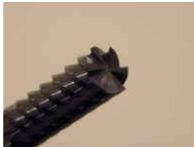
Fig.13.- Ángulo de evacuación pequeño y seis labios. Herramienta empleada para trabajo en aceros duros
