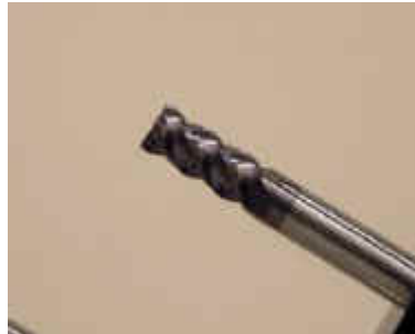
Fig. 2.- Herramienta integral plana de 4 labios. Observar los ángulos vivos, característica definitoria de las herramientas planas contra las toroidales
