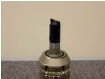
Fig 6.- Herramienta toroidal de una sola plaquita
