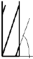
Fig.11.- Ángulo de evacuación grande y dos labios para una gran evacuación de viruta
