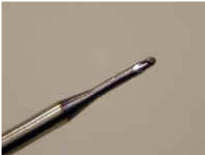
Fig. 15.- Ejemplo de una herramienta sobrealargada para el mecanizado de zonas con cierta profundidad
