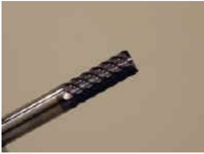
Fig. 17.- Dos ejemplos de fresa con ánima de carburo de tungsteno y recubrimiento de TiAlN
