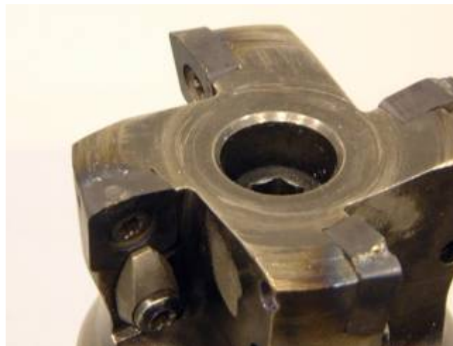
Fig. 19.- Plaquitas rotas por una mala selección de los parámetros de corte
