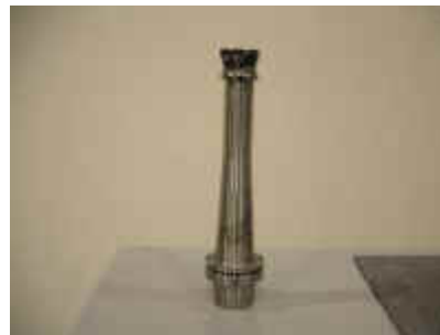
Fig. 7.- Plato de plaquitas de gran longitud para el mecanizado de zonas profundas en piezas de gran tamaño
