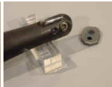
Fig. 5.- Herramientas esféricas de una sola plaquita
