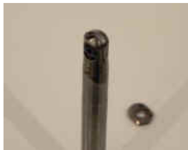
Fig. 5.- Herramientas esféricas de una sola plaquita
