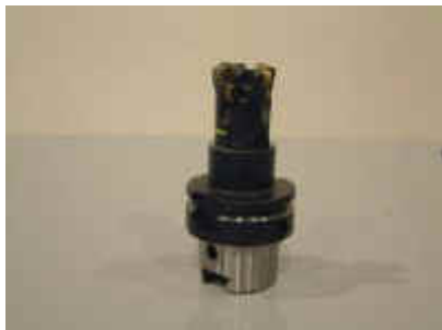
Fig. 8.- Plato de plaquitas esféricas para desbaste
