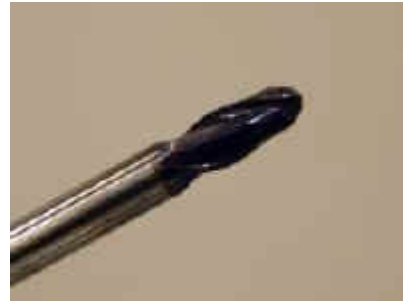
Fig. 17.- Dos ejemplos de fresa con ánima de carburo de tungsteno y recubrimiento de TiAlN
