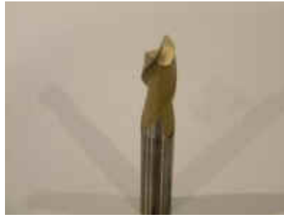
Fig.11.- Ángulo de evacuación grande y dos labios para una gran evacuación de viruta
