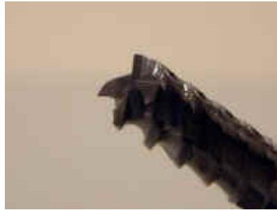
Fig.12.- Ángulo de evacuación de 45 grados aproximadamente y cuatro labios
