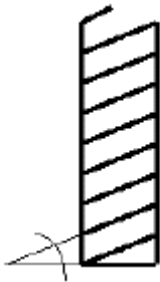
Fig.13.- Ángulo de evacuación pequeño y seis labios. Herramienta empleada para trabajo en aceros duros
